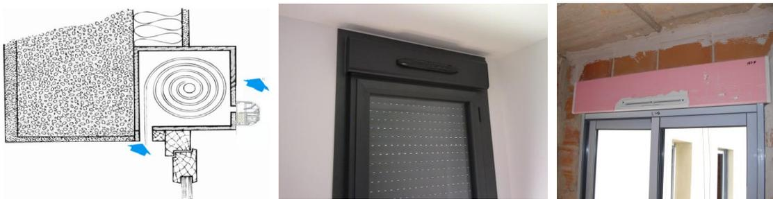
**Figura 21.** Redes termoplásticas Sistema fijación Siber
