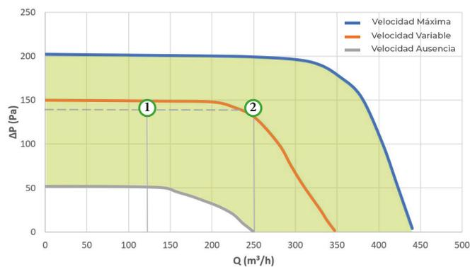
Rango de la velocidad variable entre 20% y 100%. Motor EC.
