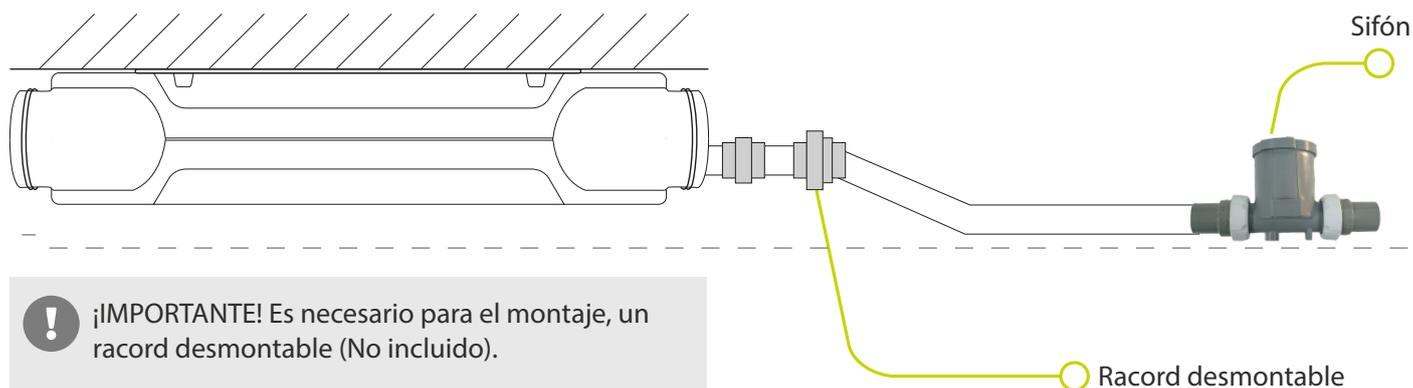
¡IMPORTANTE! Es necesario para el montaje, un racord desmontable (No incluido).
