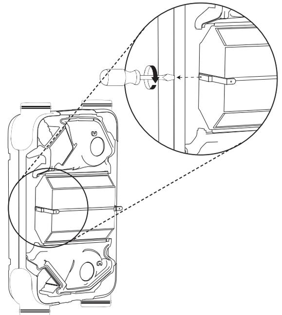
6 Separar las lenguetas de sujeción para sacar el intercambiador
