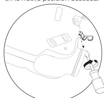
2 Perforar la superficie marcada y atornillar los soportes de fijación a través de los orificios ovalados.
