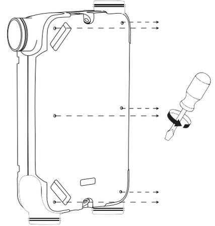
4 Retirar la tapa exterior y el polipropileno frontal de la Unidad, dejando el interior al descubierto
