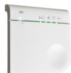
La **Sonda Siber HR (Humedad relativa) inalámbrica** controla la humedad relativa del aire interior de la vivienda. Mide la humedad interior en estancias húmedas y envía sus mediciones vía RF (radio frecuencia) a la Unidad Siber DF EVO +. La Unidad podrá reaccionar y variar el caudal de ventilación adecuado para la calidad del aire interior de acuerdo a la información de la sonda.
