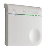
La **Sonda Siber CO<sub>2</sub> inalámbrica** controla el nivel de CO<sub>2</sub> del aire interior de la vivienda. Mide el CO<sub>2</sub> de las estancias de la vivienda y envía sus mediciones vía RF (radio frecuencia) a la Unidad Siber DF EVO +. La Unidad podrá reaccionar y variar el caudal de ventilación adecuado para garantizar la calidad del aire interior de acuerdo a la información de la sonda.
