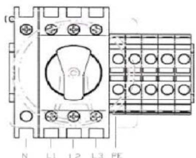
Alimente los terminales de fase L1, L2, L3 y neutro N a 400V. No te olvides de poner a tierra.
