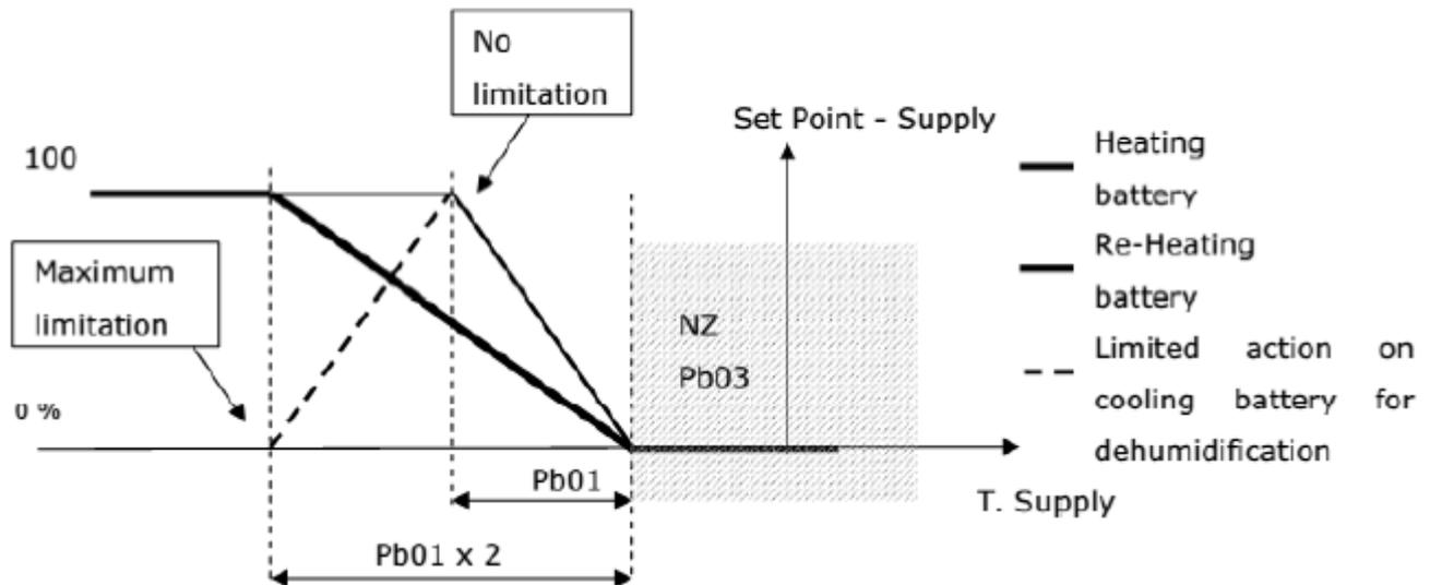
Cuando existe la solicitud de deshumidificación, el propósito de esta función de limitación es reducir el proceso de deshumidificación para evitar un enfriamiento continuo del aire y, en consecuencia, crear una demanda constante para calentar la siguiente batería.
