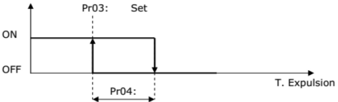
Cuando la temperatura del aire rechazado alcanza el valor de punto de ajuste Pr03, como se muestra en el diagrama, se activa una secuencia de derivación cíclica para permitir que el aire extraído (normalmente aire ambiente interior caliente) se caliente y licúe el hielo eventualmente formado en el intercambiador.
