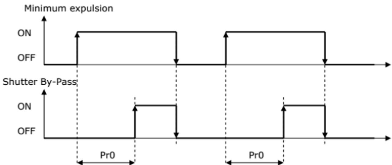
Después de un intervalo de tiempo (Pr05), se activa el bypass. Cuando la temperatura sube por encima del valor permitido, el bypass se desactiva.
