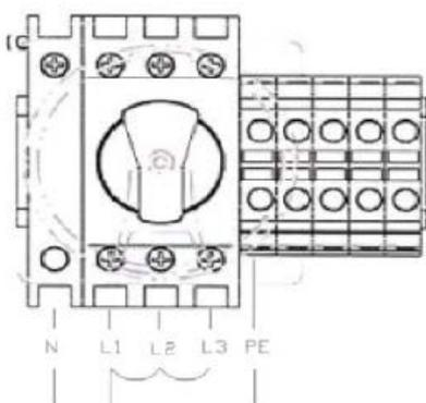
El marco se ensambla de fábrica con puentes en los terminales L1, L2 y L3.
